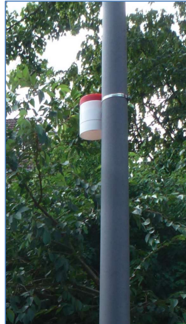
Abb. 1: NO 2 -Passivsammler mit Schutzgehäuse an Straßenlaterne exponiert.
